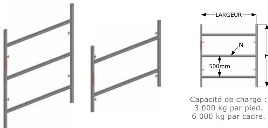
Fabriqués en tube rond de 48 mm de diamètre et de 3 mm d'épaisseur, en acier de qualité S275JR.
