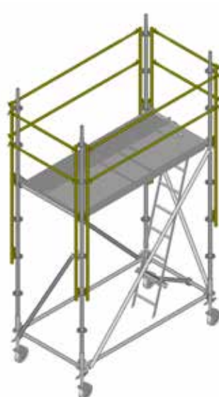
Figure 5b. Démontage de la protection latérale.
