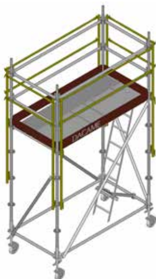
Figure 5a. Montage des garde-corps de montage.
