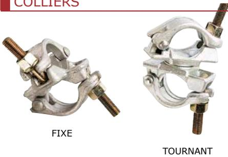
Fixation à vis. Clé de **22 mm**. Conforme EN 74-1. Charge d'utilisation 800daN au glissement. Finition galvanisée à froid.
