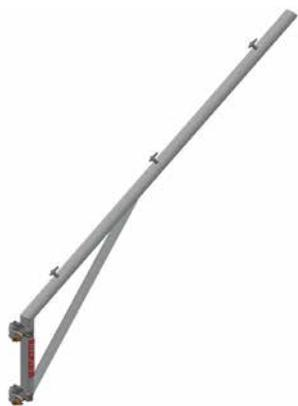
Elle est fabriquée en acier galvanisé à chaud. Elle est conçue pour arrêter la chute accidentelle d'objets provenant de la structure de l'échafaudage, laquelle est recouverte de 5 planchers en acier. Elle est fixée sur le tube vertical de l'échafaudage grâce à 2 colliers de  $\varnothing$  48 mm.
