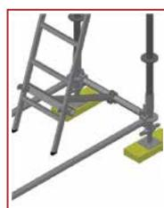
Il permet de donner l'inclinaison souhaitée à l'échelle du premier plancher d'accès, sans besoin d'utiliser des planchers en acier au niveau initial. Raccord sur le lisse via un collier de Ø 48,3 mm. Il est zingué à froid.
