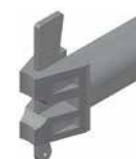
Fabriqués avec un tube de  $\varnothing 45 / 48$  mm, ils sont munis sur les deux extrémités d'étriers à clavette qui s'insèrent dans les petits orifices des rosaces. Ils servent de garde-corps (s'ils sont montés à 0,5 m et 1 m au-dessus des planchers) et d'appui pour les planchers.
