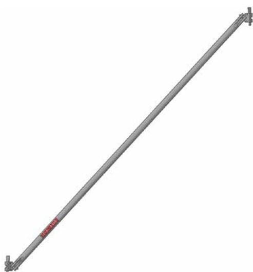
Fabriquées avec un tube de  $\varnothing 45 / 48$  mm, elles sont munies d'étriers sur leurs deux extrémités. Leur rôle est de stabiliser les plans verticaux formés par les montants verticaux et les lisses.
